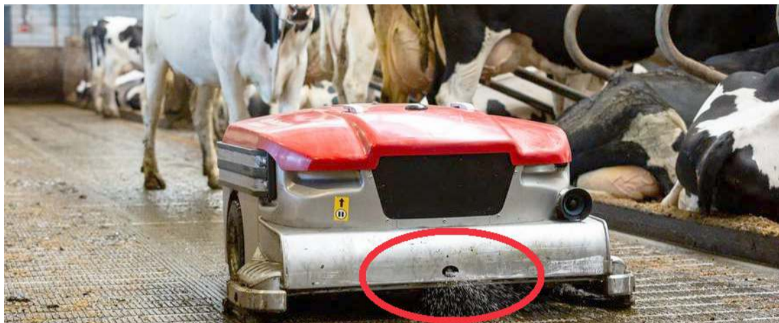
Í sérstakri tilraun verður flórgoði nýttur til þess að sprauta út bindiefni svo losun á köfnunarefni frá kúabúum með fasta flóra verði sem minnst.
